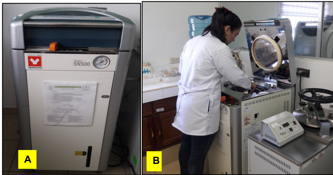
Figura 1. Preparación de medio de cultivo. En (A) Autoclave Yamato SN500 en donde se esterilizaron los medios y en (B) momento en el que se están introduciendo medios para esterilizar.
